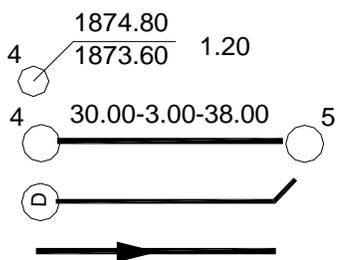
N° Pozo  $\frac{\text{Nivel de rasante} - \text{Nivel de plantilla}}{\text{Altura}}$
